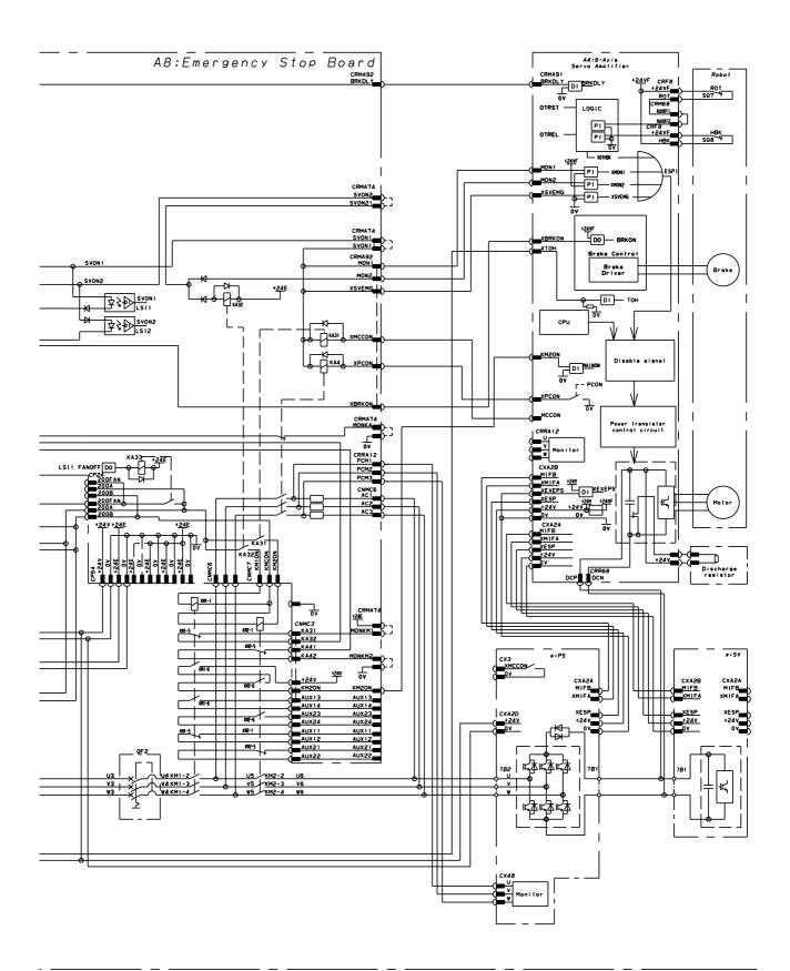
E-STOP CIRCUIT FOR B-CABINET (CONTROLLER 2) POWER SUPPLY REGENERATION
