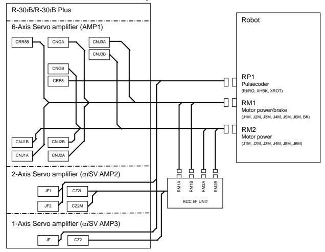
Fig.3.3.1 (d) Robot connection cable (Group5)
