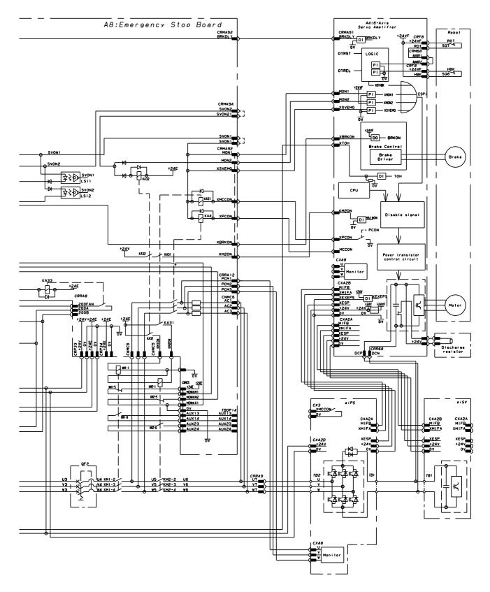
E-STOP CIRCUIT FOR B-CABINET (CONTROLLER 1) RESISTOR DISCHARGE
