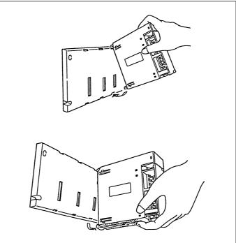
Fig.8.8.2 Replacing the module
