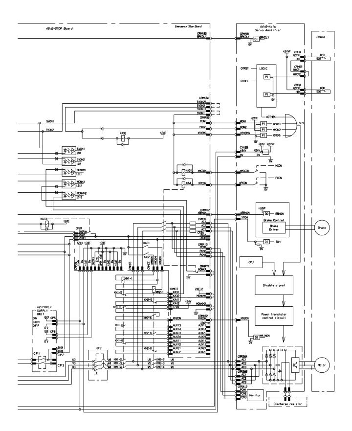
E-STOP CIRCUIT FOR B-CABINET (CONTROLLER 2) RESISTOR DISCHARGE
